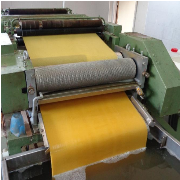
Figure 40 : Passage par le bac d'eau puis par les rouleaux gaufreurs
