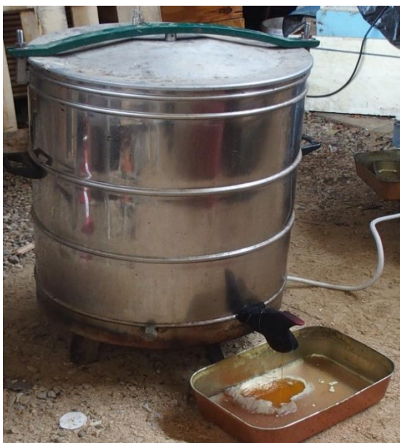
Figure 8 : Ecoulement de la cire fondue de la chaudière à vapeur
